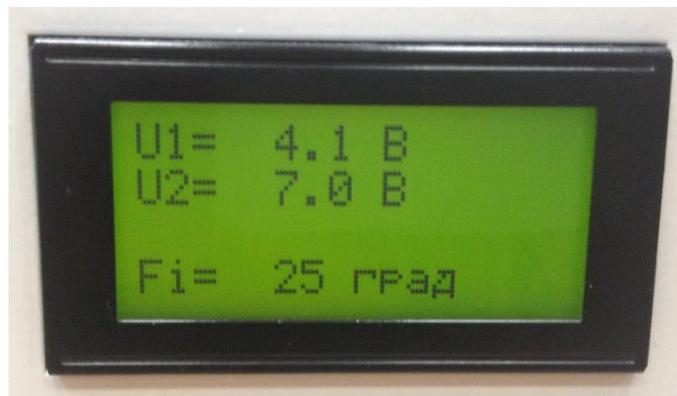
Рис. 6. Напряжение на входе цепи (опорное)  $\underline{U} = 7 \angle 0^\circ$  В, напряжение на резисторе  $R=100$  Ом (сигнальное)  $\underline{U} = 4,1 \angle 25^\circ$  В. Ток в резисторе  $\underline{I} = 0,041 \angle 25^\circ$  А.
