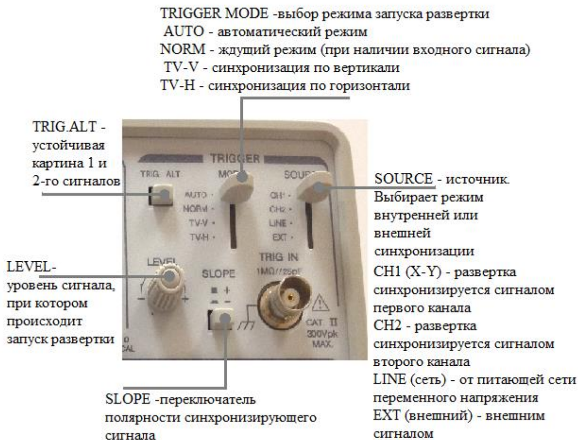
Рис. 5 Управление синхронизацией
