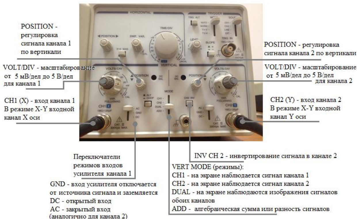
Рис 2. Расположение органов управления на передней панели осциллографа
