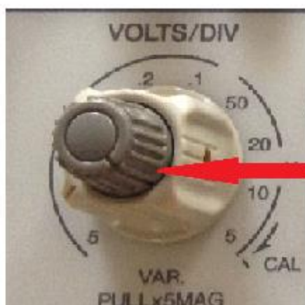
Рис. 3 Управление вертикальным масштабированием
